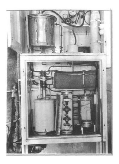
Apparatur zur Herstellung von quellwasserähnlichem Trinkwasser
